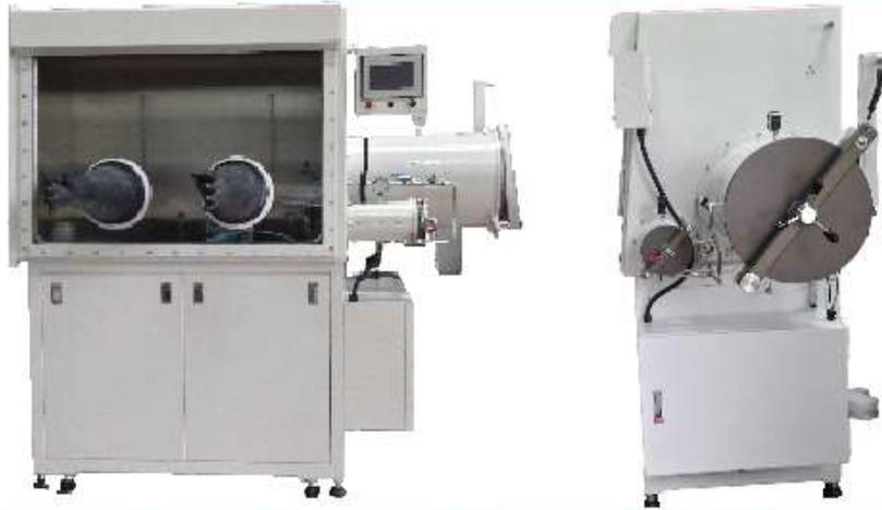
1. 尺寸：長1250mm 寬780mm 高900mm,底部骨架附輪子與高低調整腳
